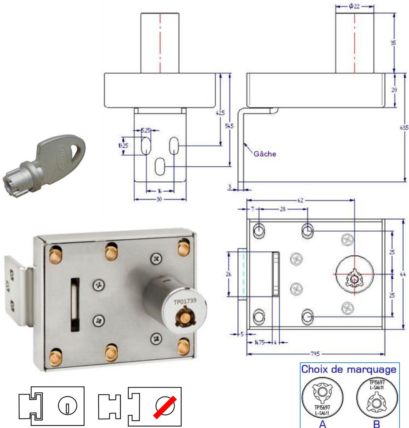
Verrou et gâche en inox AISI 304 - Cylindre laiton chromé avec goupilles et ressorts en inox AISI 303.
